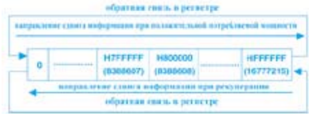
Рис. 4. Организация сдвига информации в выходном регистре счетчика
